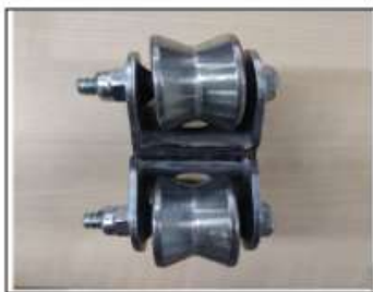
Langkah 3 : Hasil kerja proses kimpalan pada bahagian kedua-dua roda pagar.
