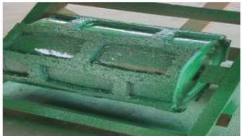
Rajah 3: Manakala saya menebuk lubang untuk penyambung boleh laras, (rujuk gambar 4), Kami melekatkan tikar getah puzzle dekat roda tong cat untuk membuat bentuk batu bata. Selepas kerja projek selesai. Proses uji lari (test rum) dilaksanakan bagi melihat keberkesanan inovasi tersebut. Kerja mengecat produk dilaksanakan selepas uji lari selesai. (Rujuk gambar 4). Saya memilih cat berwarna hijau bagi memastikan produk saya lebih menarik. Produk digosok dengan menggunakan kertas pasir berzaiz P600, P800 dan, P1000 (rujuk gambar 5)
