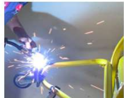
Rajah 3 : Roda dincantumkan menggunakan proses kimpalan.
