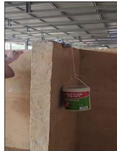
Rajah 4 : Melakukan uji lari pada projek tersebut dengan mengangkat berat barang seperti tong cat dengan menggunakan menguji tali yang bersaiz 6mm, 8mm dan 10mm dan panjangnya 3 meter.
